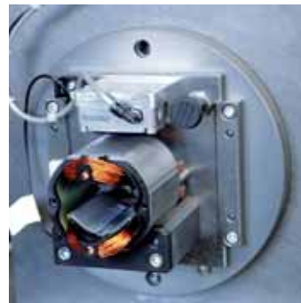
Einkleben von Flachmagneten ins Feldpaket von Elektromotoren: Der elektromechanische Minischlitten SLTE macht's möglich – und sehr präzise.
