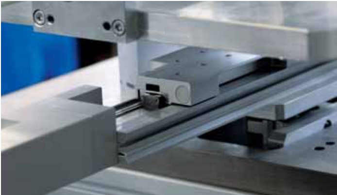
Einkleben von Flachmagneten ins Feldpaket von Elektromotoren: Der elektromechanische Minischlitten SLTE macht's möglich – und sehr präzise.
