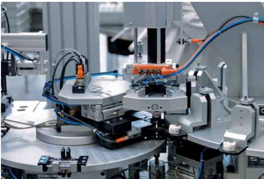
Zeit- und Kostenersparnis: Die Handhabungsachse HME als Gesamtsystem erspart umständliche Handhabungssysteme – hier beim Einpressvorgang der Federn in Kleinstmotoren
